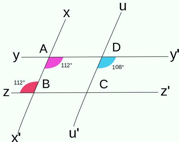
Les angles  $\widehat{x'Az}$  et  $\widehat{xBz}$  déterminés par les droites  $(yy')$ ,  $(zz')$  et la sécante  $(xx')$  sont alternes-internes. Les angles  $\widehat{x'Az}$  et  $\widehat{xBz}$  ont la même mesure. Donc les droites  $(yy')$  et  $(zz')$  sont parallèles.
