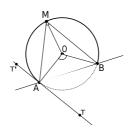
Sur la tangente, T doit être d'un côté de A bien précis, **déterminé par la condition angulaire**.
